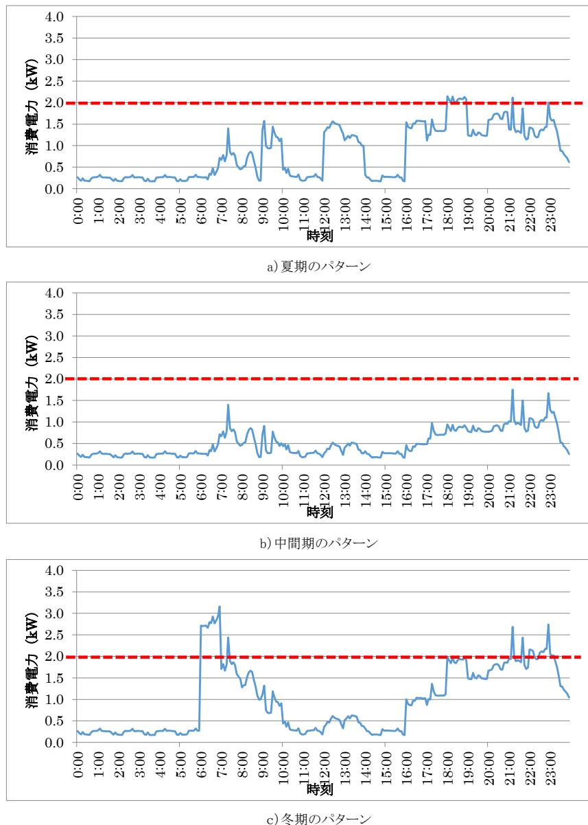
図4 標準住宅の電力負荷パターン
