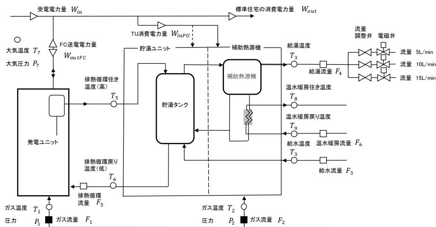
図 5 試験装置及び計測ポイント(例)
