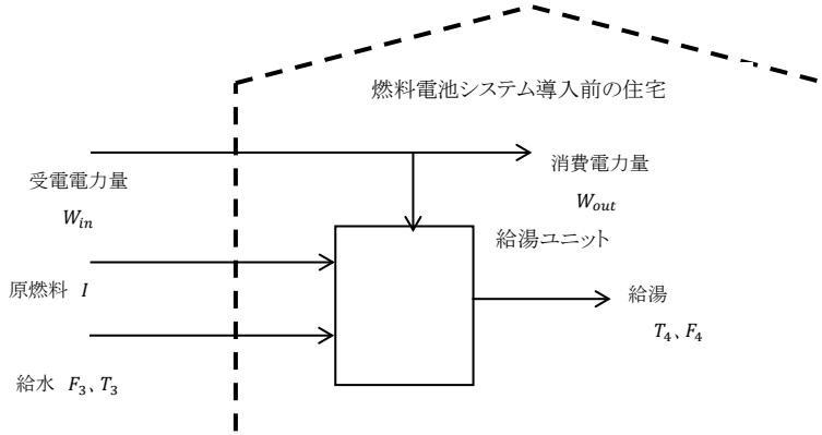
図 6 燃料電池システム導入前の住宅(例)
