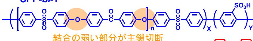
Fenton試験(加速劣化試験)
